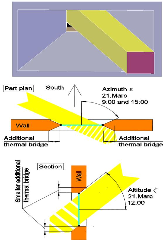
Fig. 17. Bevel edge reveal
